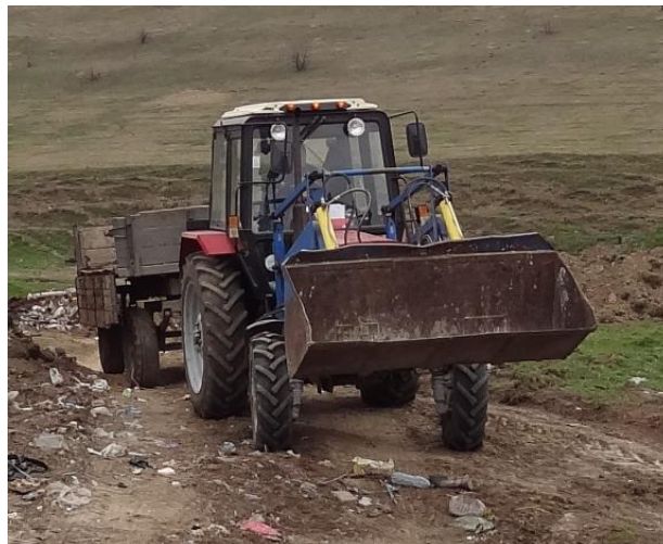
Tractor Belarus-82 TAH-192 cu remorcă de 8 m 3
