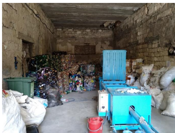
4. Presa pentru balotarea materialelor reciclabililor
