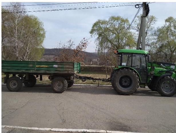
Tractor DEUTZ-Fahr cu remorcă 2PTS de 4.8 tone/4 m 3
